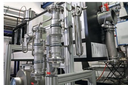
*Das Upscaling der Pyrolyseprozesse erfolgt mit einem Pyrolysedrehrohr. Die flüssigen Produkte mit den wertvollen chemischen Verbindungen werden in einer Kondensationsanlage gewonnen.*
