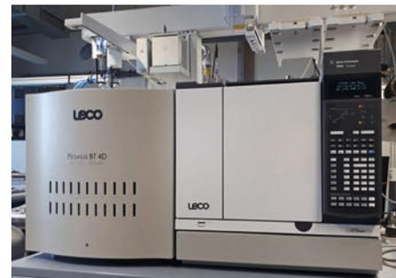
*Mit der comprehensiven Gaschromatographie-Massenspektrometrie werden komplexe Gemische organischer Verbindungen, wie z. B. synthetische Kraftstoffe oder Pyrolyseöle aus Kunststoffen, analysiert.*
